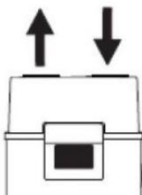
**Achtung** : Jede Hinzufügung von Zubehör(en) am lufttechnischen Teil (Winkelstück, Rohr...) wird als Anschluss mit Kanal betrachtet.
