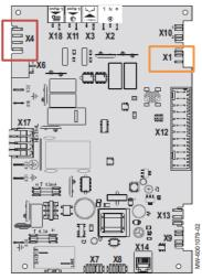
In rot: Gebläse-Stromversorgung 230V → Klemmenblock X4 der CU-HW-01 (V2.01) Leiterplatte
